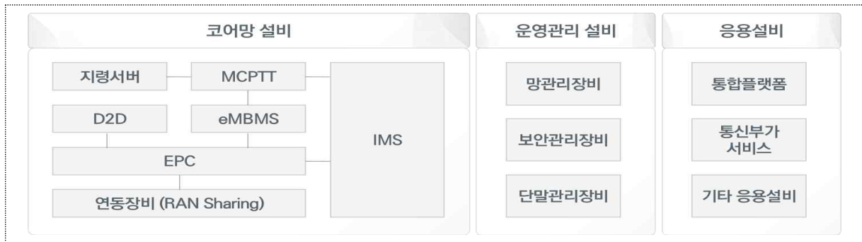
[그림 3] 재난안전통신망 주제어 설비의 기능적 구조(개략도)
